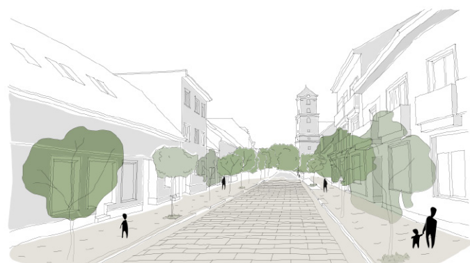
Ukopenie dopravy na Hollubýho ulici použitím dlažby a nájazdových pruhov z kamennej dlažby
